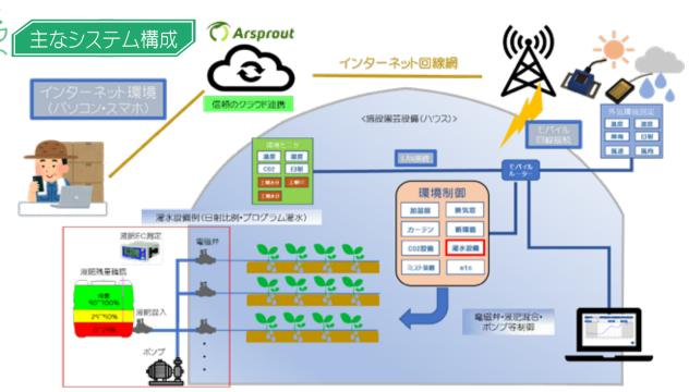
※ULink環境モニタ1台(オブション含む)・ULink制御(オブション含む)導入と制御可能設備イメージです。 ※イメージ構成は1例であり、多様な機器構成に対応可能です。※LANケーブルを含む資材などは一切含まれません。
